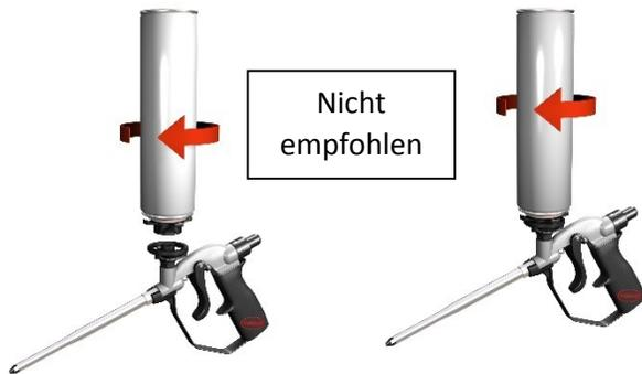
Die PU-Schaumdose sollte nicht mit dem Ventil nach unten auf die Pistole gedreht werden. Falsches aufdrehen einer PU-Schaum Kartusche. Der PU-Schaum kann bei dem vorzeigen öffnen des Ventils austreten.
