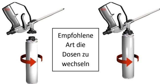
Wenn die Pistole auf eine aufrecht stehende Kartusche gedreht wird, kann beim aufschrauben kein PU-Schaum aus dem Ventil austreten.
